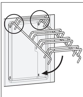
**2. Prawidłowy montaż:** Dwa haki należy stabilnie zawiesić w górnych otworach. Następnie prowadnicę powoli i ostrożnie opuszczać i zaczepiać w dolne otwory.
