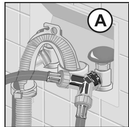
**2.** Verifique que la arandela de hule esté completamente insertada y asentada en el extremo hembra de la manguera corta antes de continuar. La arandela de hule aparece como ítem 3 en la ilustración de las piezas suministradas. Se ilustra separada de la manguera para mayor claridad.
