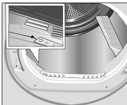
El depósito puede eliminarse fácilmente, fregando el sensor (las dos barras próximas al filtro para pelusas) mediante un paño y un poco de vinagre blanco.
