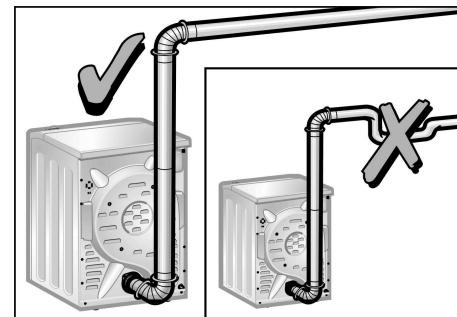
No se permiten los conductos de escape que no tengan el largo especificado en la tabla sobre longitud máxima de conductos, en la página 51. No seguir las indicaciones de esta tabla prolongará el tiempo de secado, provocará que se acumule pelusa y afectará el rendimiento y la vida útil de la secadora.
