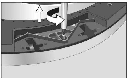
9. Retire los cuatro tornillos que sostienen el anillo delantero al cuerpo de la puerta.
