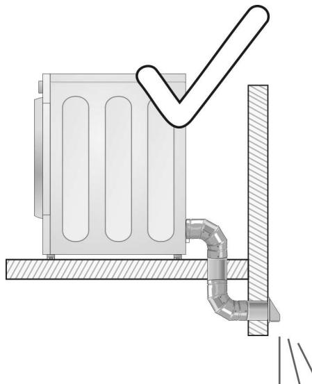
No deje que los conductos de escape se aplasten ni queden restringidos de ningún otro modo. Los conductos restringidos reducen el flujo de aire y tienen como resultado tiempos de secado más largos. Los conductos restringidos pueden reducir el flujo de aire de escape hasta causar una condición de error e incluso detener el ciclo de la secadora. Verifique que el conducto del escape no esté aplastado ni restringido.
