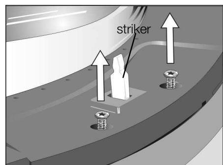
8. Retire el tornillo que estaba oculto por la cubierta de la placa del empujador.
