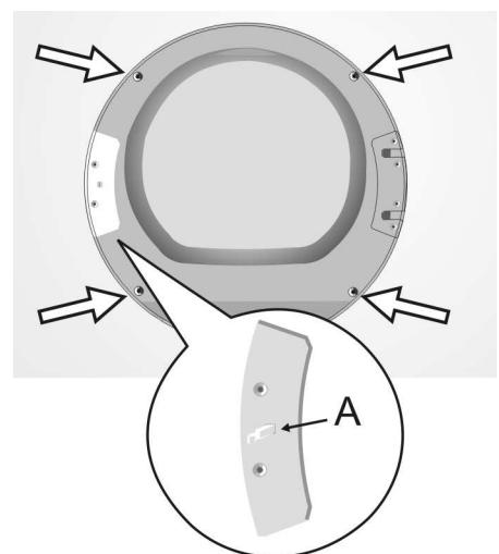
20. Retire los dos tornillos que sostienen la placa de la cubierta de plástico en la posición de montaje de la bisagra del lado izquierdo, en la carcasa de la secadora. Retire la placa y déjela a un lado con los dos tornillos.
