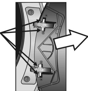
No deje que los 4 manguitos de plástico se caigan de los pasadores de la bisagra. Si alguno de los manguito se cae, vuelva a instalarlo en los pasadores de la bisagra antes de volver a instalar la puerta.
