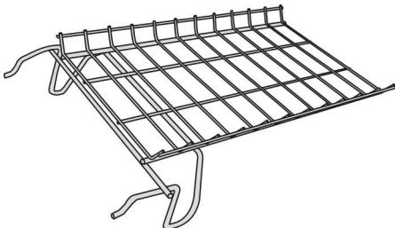
3. Sostenga la rejilla de la secadora por la sección central como se muestra a continuación e insértela completamente dentro del tambor, en sentido horizontal. Luego, vuelva a traerla hacia adelante y alinee los extremos delanteros con los dos orificios al lado del filtro atrapapapelusa.
