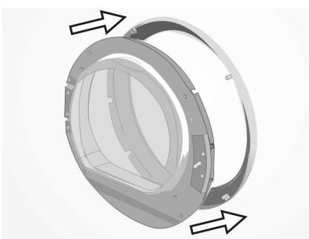
12. El vidrio de la cubierta tiene un borde de vidrio levantado que se extiende por, aproximadamente, dos tercios de la circunferencia del vidrio. Asegúrese de que este borde levantado apunte hacia arriba, mirando hacia usted. Respete la posición del borde anterior del mango de vidrio levantado, marcado con la letra (A) en la siguiente ilustración.
