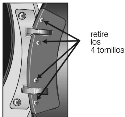
Deje a un lado la cubierta junto con los cuatro tornillos para volver a instalarlos más tarde.
