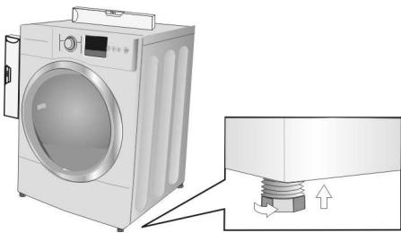
La secadora debe estar nivelada con las cuatro patas firmemente apoyadas en el suelo. La secadora no debe tambalearse. Si la secadora no está nivelada o si se tambalea, deben ajustarse las patas. Ajuste las patas de altura ajustable usando la llave de 1 pulg. (25 mm) hasta que la secadora no se balancee y esté nivelada, tanto de adelante hacia atrás como de lado a lado.
