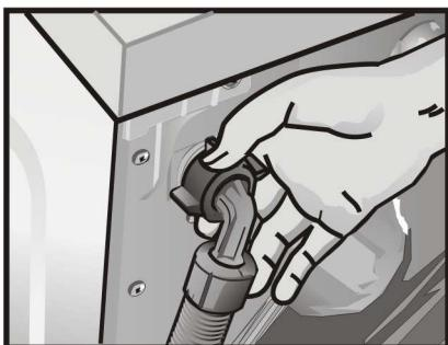
Conecte la manguera de suministro de agua del secador a un grifo de agua fría (el grifo debe estar ubicado dentro de los 4 pies (1.2 m) de la válvula de entrada de agua en la parte posterior del secador).
