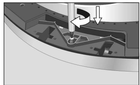
18. Gire la cubierta del empujador y el empujador 180 grados para que el conjunto calce en el área de instalación en el lado opuesto de la puerta (donde se encontraba la bisagra). Vuelva a instalar la cubierta del empujador y el empujador en la nueva ubicación, y apriete firmemente los dos tornillos de la cubierta.
