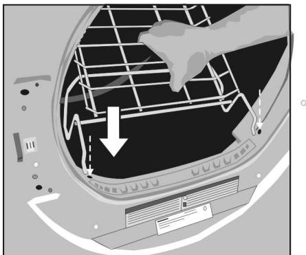
4. Con los extremos delanteros enganchados en los orificios, baje la parte trasera de la rejilla de modo tal que se asiente en su lugar, afirmada contra la superficie interna de la carcasa de la secadora.
