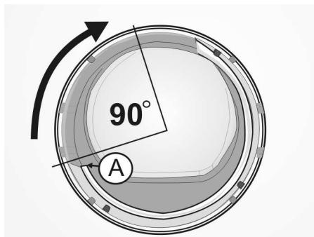
13. Fíjese en la nueva posición del vidrio de la cubierta. El borde anterior del mango de vidrio debe haberse movido 90 grados hacia la derecha desde el punto inicial, como se muestra en la siguiente ilustración, con la letra (A).
