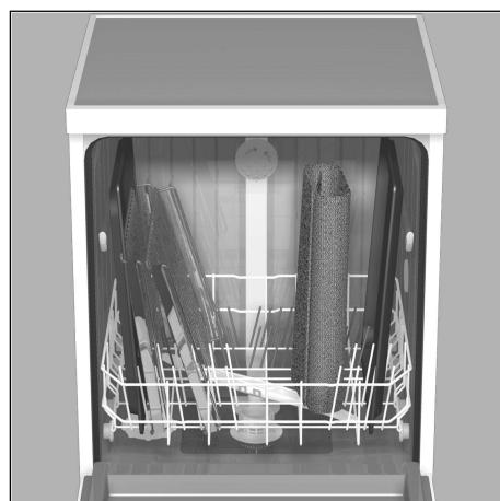
Große Bleche oder Gitter sowie Teller mit einem Durchmesser mehr als 30 cm (Gourmetteller, Pastateller, Platzteller) können Sie mit Hilfe dieses Sprühkopfes reinigen. Entnehmen Sie hierzu den Oberkorb und setzen Sie den Sprühkopf wie in der Zeichnung dargestellt ein.
