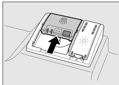
Il contenitore detersivo si apre automaticamente in funzione del programma, al momento opportuno. Il detersivo in polvere o liquido si distribuisce nell'apparecchio e si diluisce, la compressa cade nella vaschetta di raccolta compressa e qui si scioglie in modo dosato.
