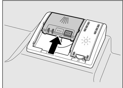
Die Reinigerkammer öffnet sich programmabhängig automatisch zum optimalen Zeitpunkt. Der Pulver- oder Flüssigreiniger verteilt sich im Gerät und wird aufgelöst, der Tab fällt in die Tab-Auffangschale und löst sich dort dosiert auf.
