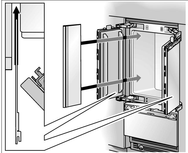
Der Fingerschutz muss sich leicht hineinschieben und herausziehen lassen!
