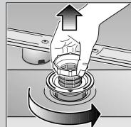
Girar el filtro cilíndrico y extraer el conjunto de filtros ...
