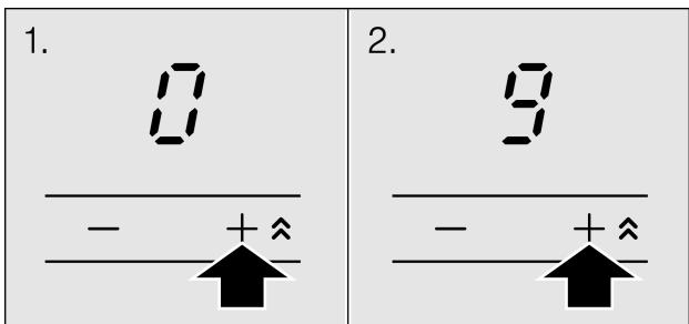
3. Changer la position de chauffe : appuyez sur le symbole + ou – jusqu'à ce que s'affiche la position de chauffe souhaitée.
