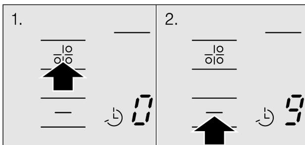
3. Modificare il grado di cottura: Selezionare la zona di cottura, quindi premere il simbolo + o - fino a quando non compare il grado di cottura desiderato.
