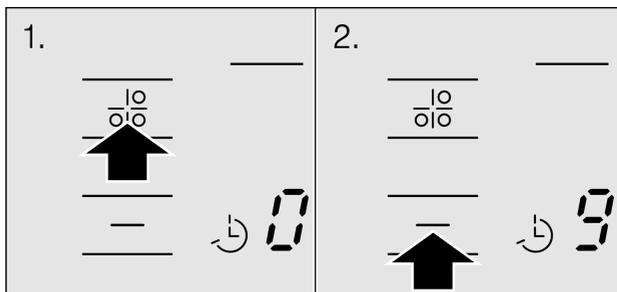
3. Changer la position de chauffe : Sélectionnez la zone de cuisson puis appuyez sur le symbole + ou - jusqu'à ce que s'affiche la position de chauffe souhaitée.
