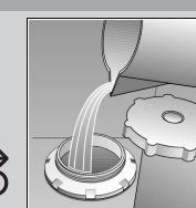
Avant le premier lavage seulement, versez env. un litre d'eau dans l'orifice du réservoir de sel.
