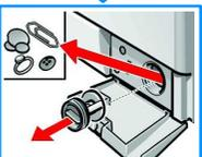
4. Nettoyez le compartiment intérieur, le filetage du couvercle de pompe et le carter de pompe (la roue à aubes de la pompe de vidange doit se laisser tourner à la main).
