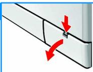
2. Pour les modèles comportant un flexible de vidange : De sa fixation, retirez le flexible de vidange puis sortez-le du corps de l'appareil. Retirez la coiffe obturatrice, laissez le bain lessiviel s'échapper. Enfoncez la coiffe obturatrice et mettez le flexible de vidange en place dans la fixation.
