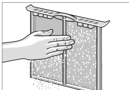
4. Retirez les peluches en frottant les doigts sur le filtre.
