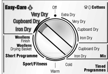
Le séquencement des programmes automatique est contrôlé par des capteurs. La durée du programme dépend du niveau d'humidité mesuré dans le linge et du degré sélectionné d'humidité résiduelle qu'il doit atteindre (par ex. **Iron Dry** or **Extra Dry** (Prêt à repasser ou Extra sec)).
