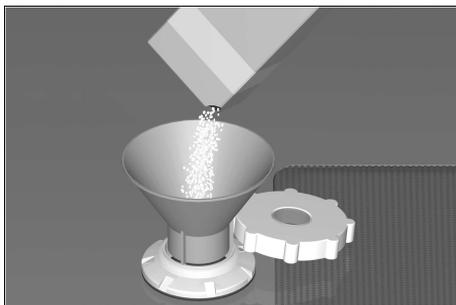
A l'aide de l'accessoires de remplissage livré d'origine, versez autant de sel (**il ne s'agit pas de sel alimentaire**) jusqu'à ce que le réservoir de sel soit plein (1,5 kg max.). Lorsque vous versez le sel, cette action refoule l'eau qui s'écoule. Pour cette raison, il faut toujours rajouter du sel immédiatement avant d'enclencher le lave-vaisselle. (Pour éviter la corrosion). De la sorte, la solution saline débordante est immédiatement diluée et évacuée.
