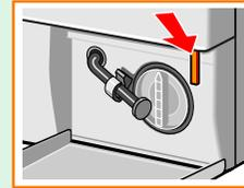
Das Programm läuft weiter, wenn der Strom wieder fließt. Soll dennoch die Wäsche entnommen werden, kann das Einfüllfenster wie nachfolgend beschrieben geöffnet werden:
