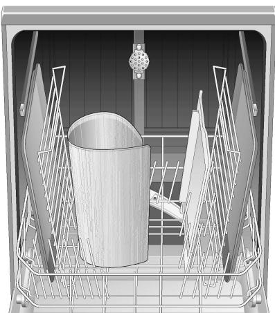
Con este cabezal pulverizador se pueden lavar bandejas pasteleras de gran tamaño, así como platos con un diámetro superior a 30 cm (por ejemplo platos para pasta, etc.). A tal efecto deberá retirarse el cesto superior del lavavajillas, montando el cabezal pulverizador en la máquina tal como se muestra en la ilustración.
