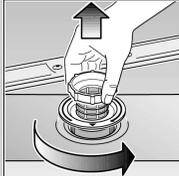
Siebzylinder drehen, Siebssystem entnehmen ...
