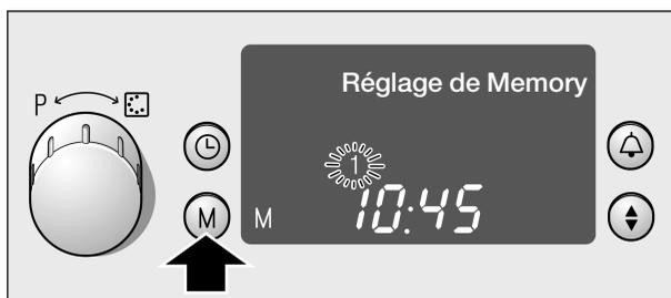
Pour un autre emplacement-mémoire, appuyer sur la touche «M» jusqu'à ce que le numéro souhaité apparaisse.
