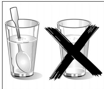
Un retard d'ébullition peut se produire lorsque vous chauffez des liquides. Cela signifie que la température d'ébullition est atteinte sans que les bulles de vapeur typiques remontent. A la moindre secousse ou vibration, le liquide chaud peut alors subitement déborder ou jaillir. Risque de brûlures !
