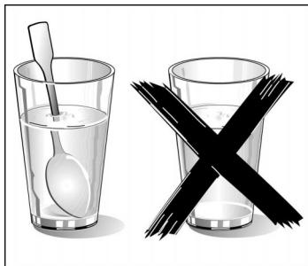
Durante il riscaldamento di liquidi si può verificare un ritardo del processo di ebollizione. In altri termini, la temperatura di ebollizione viene raggiunta senza che si formino le tipiche bollicine di vapore. Anche un leggero urto del recipiente può causare un improvviso trabocco del liquido o la formazione di spruzzi. Pericolo di scottature!
