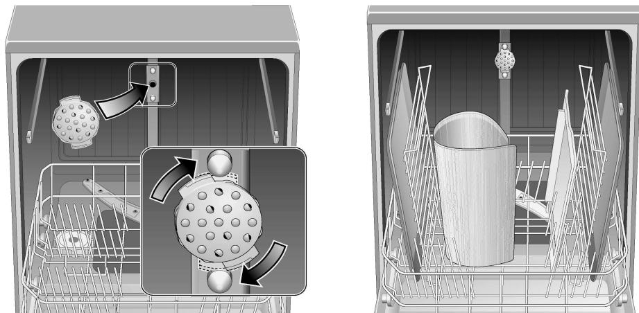
Con este cabezal pulverizador se pueden lavar bandejas pasteleras de gran tamaño, así como platos con un diámetro superior a 30 cm (por ejemplo platos para pasta, etc.). A tal efecto deberá retirarse el cesto superior del lavavajillas, montando el cabezal pulverizador en la máquina tal como se muestra en la ilustración.
