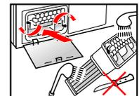
9. Wartungsklappe schließen bis Verriegelung einrastet.
