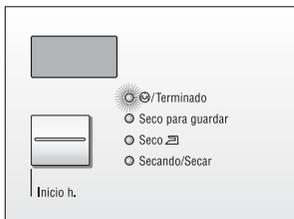
En los programas estándar, la secadora trabaja con un sistema de captación que controla de forma constante la humedad de la ropa. El secado finaliza automáticamente tan pronto como se haya alcanzado el grado de secado seleccionado. El estado de programa se señala con unas lámparas indicadoras (LED).
