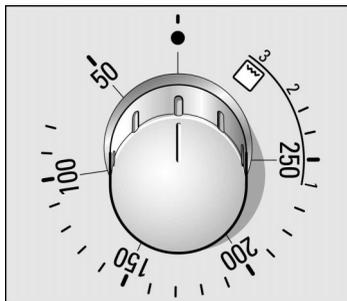
Le thermostat permet de régler la température ou la position grill.
