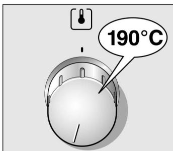
2. A l'aide du thermostat, régler la température ou la position grill.
