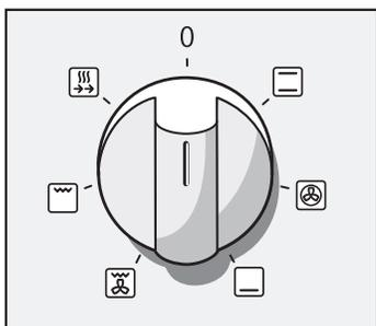
Le sélecteur de mode de fonctionnement permet de régler le mode de cuisson du four. Il se tourne vers la droite ou vers la gauche.
