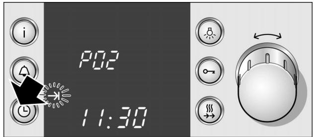
6. Mit dem Drehkopf die Endezeit auf später verschieben.
