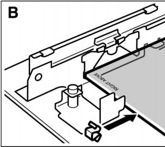
3. Die kleinen Klammern wieder an der unteren Glasscheibe aufstecken. (Bild B)
