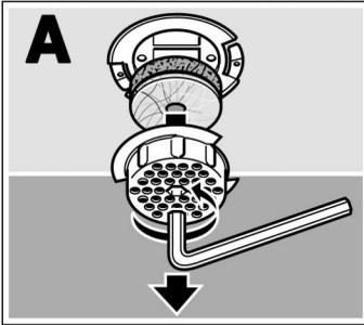
1. Mit einem Sechskantschlüssel (6 mm) den Filtertopf nach links drehen und abnehmen. Bild A.
