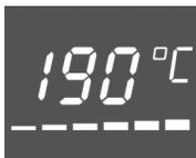
Die Aufheizkontrolle zeigt den Temperaturanstieg im Backofen an. Wenn alle Felder gefüllt sind, ist der optimale Zeitpunkt zum Einschieben des Gerichtes erreicht.
