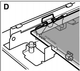
5. Die Haltefedern rechts und links nach außen drücken, so dass die Scheibe aufliegt. (Bild D)
