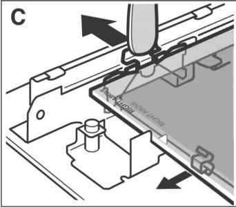
4. Die Haltefedern rechts und links vorne nacheinander nach außen drücken. Sollten sich die Klammern schwer zur Seite drücken lassen, nehmen Sie einen Löffel zu Hilfe. (Bild C)
