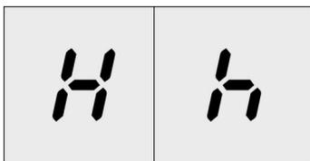
Il piano di cottura è dotato di un indicatore di calore residuo per ciascuna zona di cottura. Tale indicatore segnala quali sono le zone di cottura ancora a temperatura elevata. L'indicatore di calore residuo presenta due gradi.
