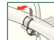
2. Desserrez les 4 vis des brides de transport jusqu'à ce qu'elles soient mobiles dans les douilles.
