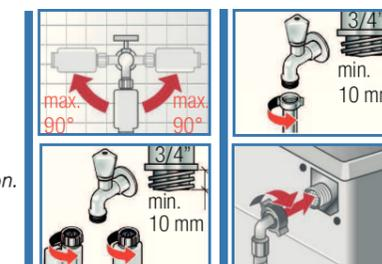
2. Ouvrez le robinet d'eau avec précaution et vérifiez l'étanchéité des points de raccordement.
