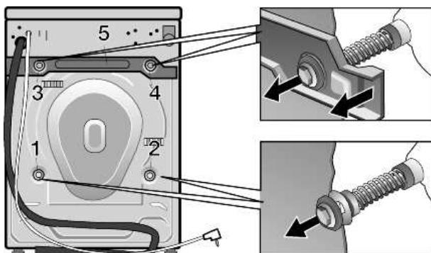
Las piezas de los seguros para el transporte del interior del aparato se desprenden y se caen al suelo, debajo de la lavadora.
