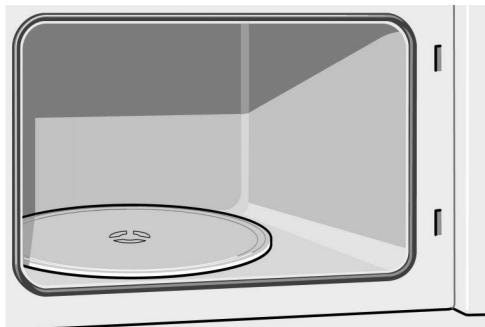
Gebruik de magnetron enkel met de draaischijf. Zorg ervoor dat dehouder goed vastzit. De draaischijf kan naar links of naar rechts draaien.
