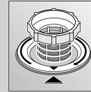
enroscar el filtro cilíndrico.
