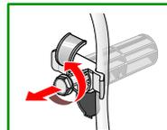
**3.** Alle 4 Transportsicherungen komplett entfernen und die Netzleitung aus den Halterungen nehmen.
