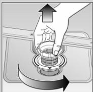
Rodar o filtro cilíndrico, retirar o sistema de filtros ...
