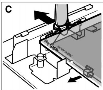
4. Pousser l'un après l'autre les ressorts de fixation à l'avant à droite et à gauche vers l'extérieur. Si les pattes se laissent pousser difficilement vers le côté, utiliser une cuillère. (Fig. C)
