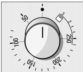
Le thermostat permet de régler la température ou la position gril.
