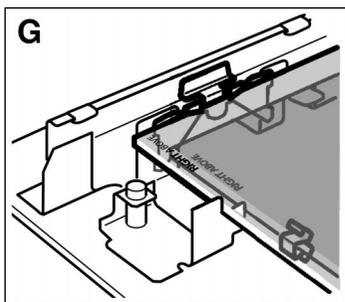
5. Pousser vers l'extérieur les ressorts de fixation à droite et à gauche, de sorte que la vitre repose. (Fig. G)
