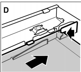
1. Engager la vitre inférieure en l'inclinant vers l'arrière. (Fig.D)
