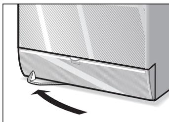
Pour mettre l'appareil sur roulettes, faites pivoter de droite à gauche le levier situe sous l'avant de l'appareil.
