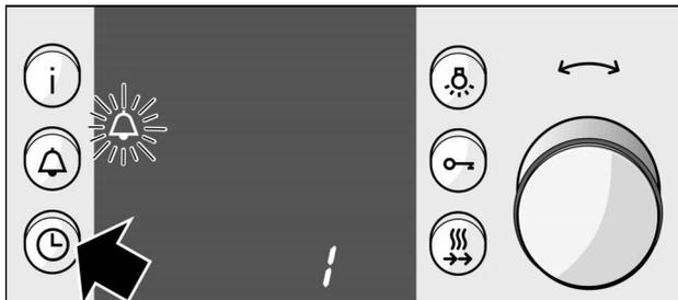
Zmienić nastawienie podstawowe zgodnie z punktem 2 i potwierdzić naciśnięciem przycisku zegara ⌚. Teraz można jeszcze zmienić nastawienie czasu przejmowania. Na końcu nacisnąć przycisk zegara ⌚.
