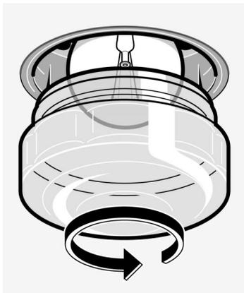
Zepsuta lampka w piekarniku musi zostać wymieniona. Odporne na temperaturę lampki zapasowe, 40 W, można nabyć w punkcie serwisowym lub w specjalistycznych placówkach handlowych.
