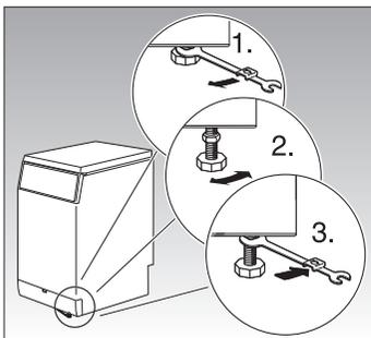
Les quatre pieds de l'appareil doivent reposer fermement sur le sol. Le lave-linge ne doit pas vaciller.
