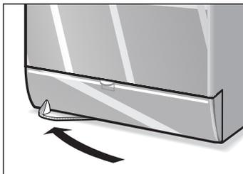
Pour mettre l'appareil sur roulettes, faites pivoter de droite à gauche le levier situé sous l'avant de l'appareil.
