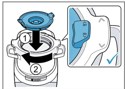
5. Den inneren Deckel im Uhrzeigersinn drehen, bis dieser einrastet.
