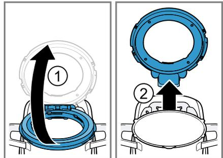
7. Den äußeren Deckel mit Dichtung aus der Deckelhalterung entnehmen.
