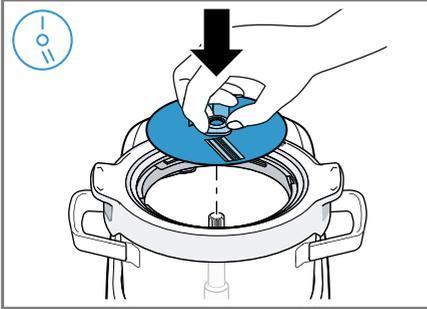
6. Den inneren Deckel mit Einfüllschacht auf die Abdeckung für den Deckelrand setzen.
