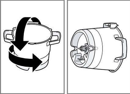
3. Den Schraubring mit Flügeln bis zum Anschlagpunkt drehen.
