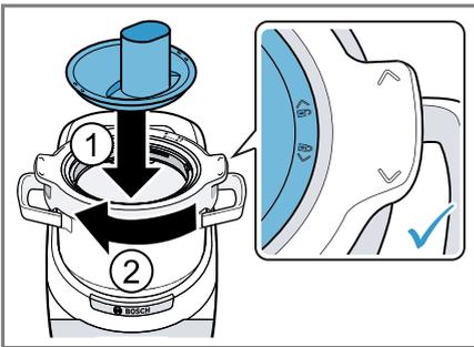
7. Den inneren Deckel mit Einfüllschacht im Uhrzeigersinn verriegeln.
