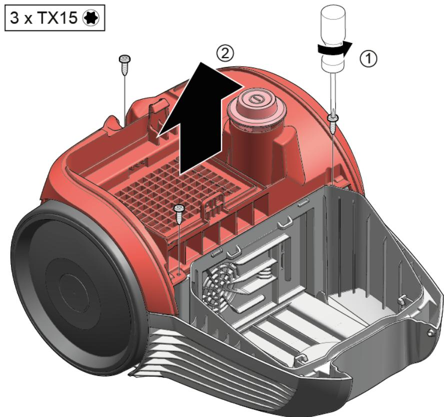
4. Retirer le boîtier du capuchon (selon le modèle de l'appareil).
