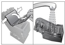
■ 在水龙头下将酿造装置的过滤器冲洗干净。
