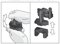
■ 拆开导奶管、连接件以及牛奶软管。
