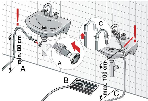
Odtokovú hadicu namontujte so zvyšným príslušenstvom podľa schémy pripojenia (A, B alebo C).
