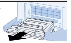
Das Flusendepot aufklappen und die Flusen entfernen.
