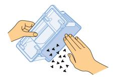
Die Innenseite der Abdeckung und des Flusensiebs unter fließendem Wasser spülen und mit einem Tuch trocknen. Bei starker Verunreinigung eine weiche
