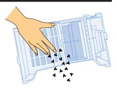
Das entleerte Flusendepot unter fließendem Wasser spülen und trocknen.
