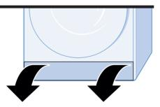
Die Hebel der Wärmetauscher-Abdeckung entriegeln und am Griff heraus ziehen.
