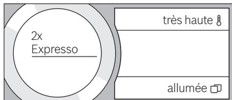
■ Placer deux tasses, une à gauche et une à droite, sous la buse d'écoulement.
