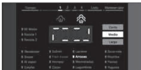
El aparato calienta la olla hasta que se alcanza la presión de vapor preestablecida. Durante la fase de calentamiento, se ven líneas en la pantalla de visualización que se iluminan en sentido horario.
