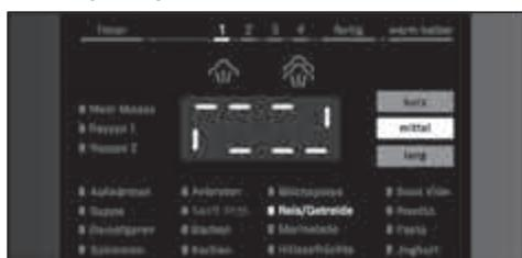
Das Gerät heizt den Topf auf, bis die Ziel-Temperatur erreicht ist. Während der Aufheizphase erscheinen im Display Linien, die im Uhrzeigersinn aufleuchten.
