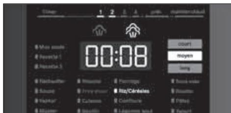
Si la durée de préparation se termine, un signal sonore retentit, l'affichage clignote et la lettre « P » s'affiche. De la vapeur est automatiquement évacuée par à-coups de l'appareil afin de supprimer la pression à l'intérieur de l'appareil.
