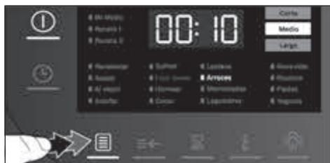
En el panel de mando se ilumina el LED correspondiente y parpadea el tiempo preestablecido para el programa de elaboración seleccionado. Se iluminan el elemento indicador «baja presión de vapor» [ ] o «alta presión de vapor» [ ]. Pulsar la tecla [ ] para cambiar entre [ ] y [ ].
