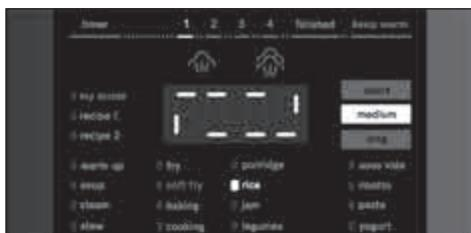
L'apparecchio riscalda il recipiente fino al raggiungimento della temperatura imposta. Durante il riscaldamento, sul display compaiono delle lineette che si accendono in senso orario.
