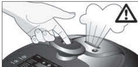
2. Aprire l'apparecchio aprendo la manopola di blocco pressione (-Θ-) e premendo il tasto di apertura sull'apparecchio base.
