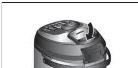
**19. Inserire il contenitore dell'acqua di condensa**
