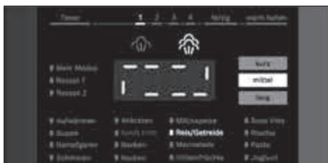
Das Gerät heizt den Topf auf, bis der voreingestellte Dampfdruck erreicht ist. Während der Aufheizphase erscheinen im Display Linien, die im Uhrzeigersinn aufleuchten. Sobald der voreingestellte Dampfdruck erreicht ist, erlöschen die Linien und die Zubereitungszeit wird im Display angezeigt.
