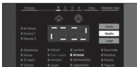
El aparato calienta la olla hasta que se alcanza la temperatura deseada. Durante la fase de calentamiento, se ven líneas en la pantalla de visualización que se iluminan en sentido horario.
