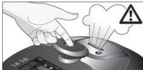
2. Das Gerät öffnen. Hierzu den Druck-Verriegelungs-Griff öffnen (⊖) und die Öffnungstaste am Grundgerät drücken.
