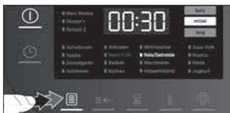
Im Bedienfeld leuchtet die entsprechende LED auf und die voreingestellte Zubereitungsdauer für das gewählte Zubereitungsprogramm blinkt.
