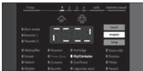
L'appareil chauffe le récipient jusqu'à ce que la température souhaitée soit atteinte. Au cours de la phase de chauffage, des lignes apparaissent sur l'écran d'affichage et tournent dans le sens des aiguilles d'une montre.
