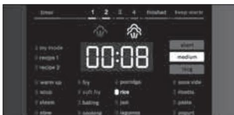
Al termine del tempo di preparazione viene emesso un segnale acustico, il display lampeggia e indica "P". Dall'apparecchio esce automaticamente il vapore, a scatti, per abbassare la pressione all'interno dell'apparecchio.
