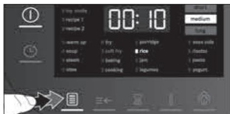
Sul pannello di comando si accende il LED corrispondente e la durata preimpostata del programma selezionato lampeggia. Gli indicatori "pressione vapore bassa" [↑] o "pressione vapore alta" [↓] sono accesi. Premere il tasto ↕ per passare da [↑] a [↓] e viceversa.
