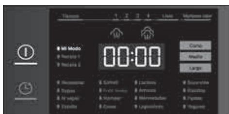
**Nota:** Si durante 5 minutos no se ejecuta ninguna acción en el panel de mando, el aparato conmuta automáticamente al modo de espera.
