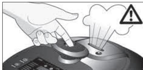
2. Ouvrir l'appareil. Ouvrir la poignée de verrouillage pression (-) et appuyer sur le bouton d'ouverture situé sur l'appareil de base.
