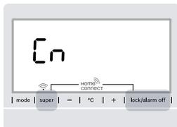
Pulsar las dos teclas exactamente al mismo tiempo. Las teclas se bloquean si, durante un tiempo prolongado, solo se pulsa la tecla «**lock/alarm off**». Volver a pulsar la tecla «**lock/alarm off**» y mantenerla pulsada hasta que las teclas se desbloqueen.
