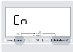
Premete contemporaneamente i due tasti. I tasti vengono bloccati se si preme a lungo il tasto **"lock/alarm off"** da solo. Premete nuovamente il tasto **"lock/alarm off"** finché i tasti non si sbloccano.
