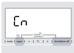
Premete contemporaneamente i due tasti. I tasti vengono bloccati se si preme a lungo il tasto **"lock/ alarm off"** da solo. Premete nuovamente il tasto **"lock/alarm off"** finché i tasti non si sbloccano.
