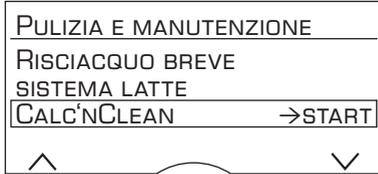
Durante le singole fasi di Calc'nClean, il tasto **8 start** lampeggia. I numeri indicati in alto a destra indicano l'avanzamento della procedura.
