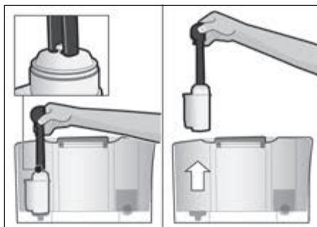
**i** Efter skyldningen af filteret er visningen "Skift vandfilteret" blevet aktiveret. Efter denne visning eller senest efter 2 måneder har filteret ikke længere nogen virkning. Det skal udskiftes af hygiejniske grunde, og for at maskinen ikke kalkrer til (maskinen kan tage skade).
