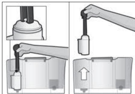
**i** Suodattimen huuhtelu on aktivoinut automaattisesti näytön "Vaihda vedensuodatin"-asetuksen. Suodattimen teho on päättynyt tämän näytön tullessa tai viimeistään kahden viikon kuluttua. Suodatin on vaihdettava sekä hygieenisistä syistä että laitteen kalkkeutumisen estämiseksi (laite voi vaurioitua).
