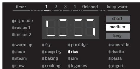
Apparatet opvarmer gryden, indtil måltemperaturen er nået. Under opvarmningsfasen viser displayet linjer, der tændes i urets retning.
