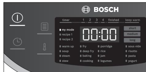
**Merk:** Hvis det ikke gjøres noen innstillingar på betjeningsfeltet i løpet av 5 minutter, skiftr apparatet automatisk til standby-modus.
