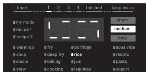
Laite kuumentaa astiaa, kunnes asetettu lämpötila on saavutettu. Kuumennusajan kuluessa näyttöön ilmestyy viivoja, jotka sytytivät vuorotellen myötäpäivään. Kun asetettu lämpötila on saavutettu, viivat katoavat näytöstä ja valmistusaika tulee näkyviin.
