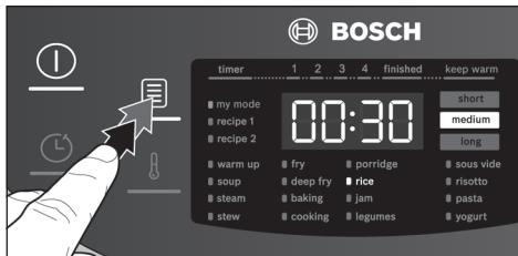
I betjeningsfeltet tennes tilhørende LED, og forhåndsinnstilt tilberedningstid for valgt tilberedningsprogram blinker.
