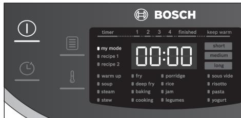
**Huomautus:** Jos ohjauspaneeliin ei tehdä muutoksia 5 minuuttiin, laite siirtyy automaattisesti valmiustilaan.
