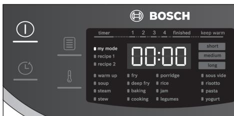
**Bemærk:** Hvis der i 5 minutter ikke foretages nogen indtastning i betjeningsfeltet, skifter apparatet automatisk til standbytilstand.
