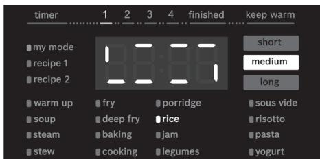
O aparelho aquece a panela até atingir a temperatura pretendida. Durante a fase de aquecimento, o visor exibe linhas que se acendem no sentido dos ponteiros do relógio.
