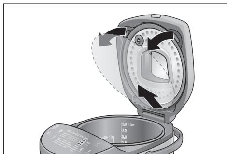
**7. Levantar a panela do interior do aparelho.**
