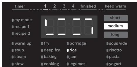
Het apparaat warmt de pan op tot de gewenste temperatuur is bereikt. Tijdens de opwarmfase verschijnen lijnen op het display, die rechtsom roteren.
