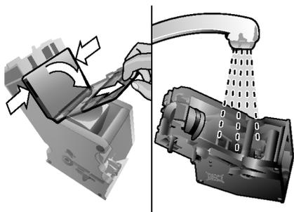
7. Почистете основно филтъра на запарващото устройство под течаща струя вода.
