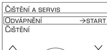
Během jednotlivých odvápňovacích postupů bliká tlačítko **8 start**. Číslice vpravo nahoře zobrazují jednotlivé fáze programu.
