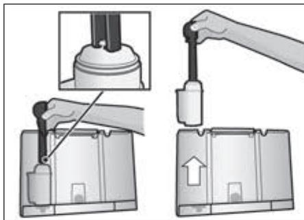
**Informacja:** Płukanie filtra **29** włącza jednocześnie ustawienie dla wskazania wymiany filtra.
