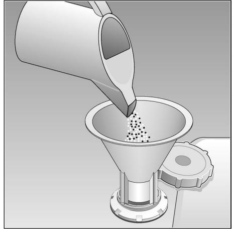
El piloto de aviso de la reposición de la sal 7 en el cuadro de mandos se ilumina y se apaga sólo al cabo de cierto tiempo, una vez que la concentración de sal en el agua de la instalación de descalcificación ha alcanzado una concentración suficiente.
