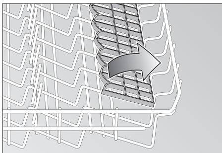
Las piezas largas como cubiertos para ensalada, cucharones (de cocina) o cuchillos se colocan en el soporte adicional para vasos y tazas, de modo que no obstruyan el movimiento del brazo aspersor. El suplemento se puede mover libremente.
